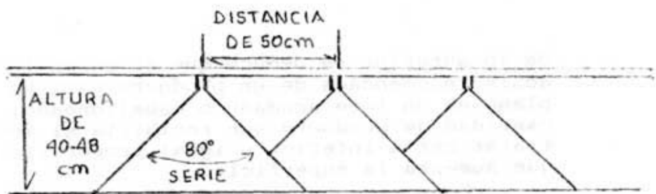
Fig. 2. Altura del aguilon con boquillas de abanico plano (ree-set)
