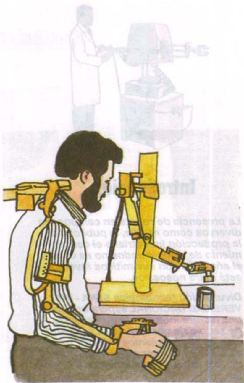
BRAZO TELEQUIRICO Repite con precisión los movimientos del operario
