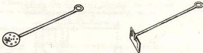
Espumadores para ser introducidos en el metal líquido.
